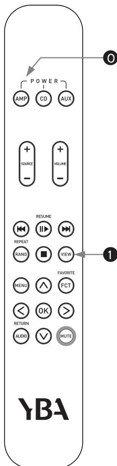
0 Sélectionnez l'appareil que vous souhaitez contrôler entre AMP, CD et AUX. Pour contrôler l'A6, vous devez sélectionner le bouton AMP.
