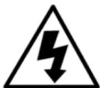
Изображение в виде молнии с концом в виде наконечника стрелы, находящейся в равностороннем треугольнике, предназначено для того, чтобы предупредить пользователя о наличии не изолированных источников высокого напряжения в корпусе устройства количество которых может быть достаточным для предупреждения о риске поражения электрическим током.
